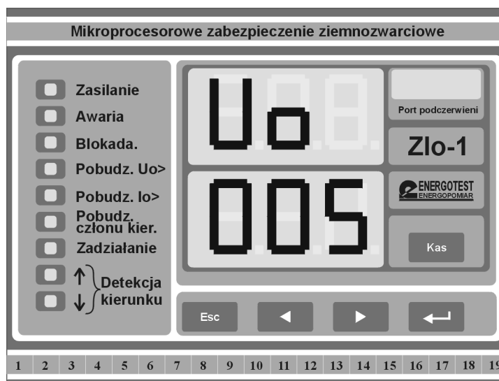
Rys. 11. Widok panelu czołowego zabezpieczenia Zlo-1.
