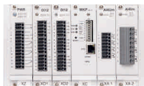
Przykładowa konfiguracja rejestratora 1/2 19 cali - 2 karty dwustanowe (24 wejścia) oraz 2 karty analogowe (8 pomiarów).
