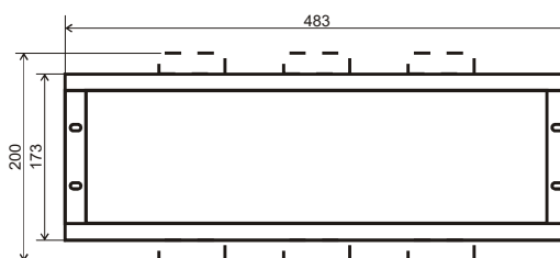
WYMIARY AUTOMATU AZR W WERSJI 11 OBUDOWA ZATABLICOWA KASETA EURO 84T (APRA)
