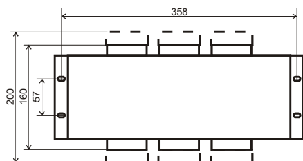
WYMIARY AUTOMATU AZR W WERSJI 5 OBUDOWA NATABLICOWA KASETA EURO 63T (APRA)
